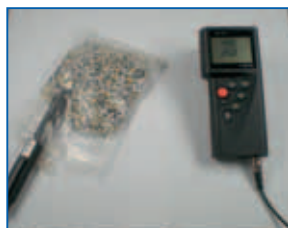
Materialausgleichsfeuchte, z. B. Kunststoff, Holz, Glas etc Measures equilibrium moisture in masonry, cement, plastic granulate
